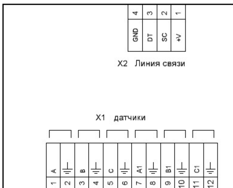
Схема подключения коммутатора СКВН2
