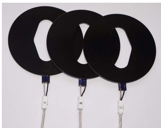
Рисунок 2. Подизоляторные датчики высокого напряжения
